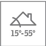
Pente de la fenêtre de toit superposée à la VFE : de 15° à 55°
